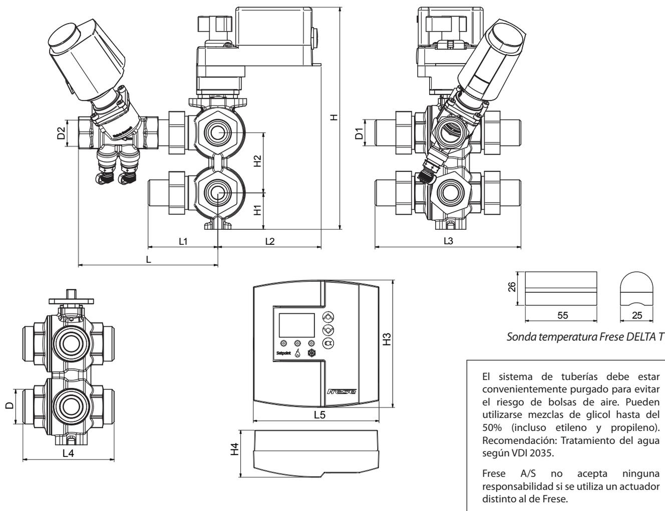
El sistema de tuberías debe estar convenientemente purgado para evitar el riesgo de bolsas de aire. Pueden utilizarse mezclas de glicol hasta del 50% (incluso etileno y propileno). Recomendación: Tratamiento del agua según VDI 2035.
