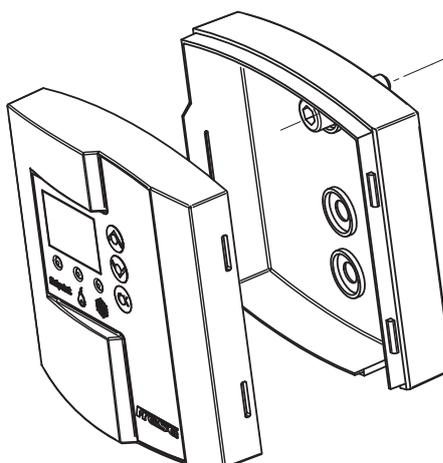
*Unidad de control OPTIMIZER 6 montado en superficie.*
