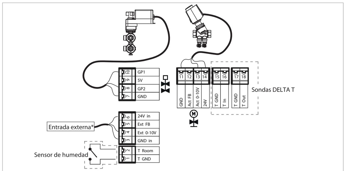
\*) Tener en cuenta que se necesita alimentación de **24V CA** cuando se utiliza un actuador electrotrémico. Cuando se utiliza un actuador distinto, la alimentación de la unidad de control debe ser la misma que la del actuador, CA o CC.
